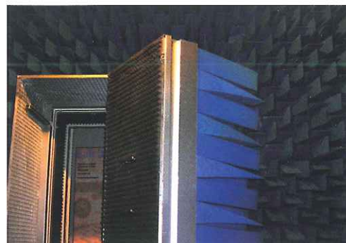
Cámara anecoica para ensayo acústico
